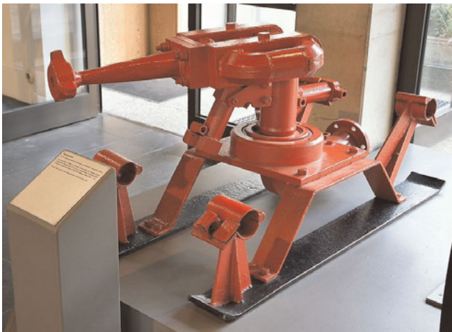
Abb. 1: Der Prototyp für erste Versuche zur hydromechanischen Kohlegewinnung von 1962
