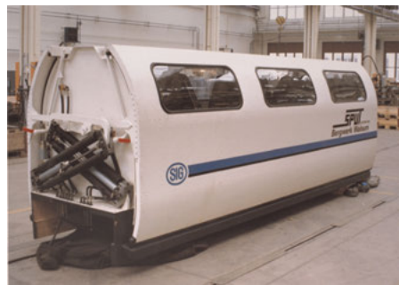
Abb. 8: Das Mock-Up im SIG-Werk. Gut zu sehen sind die Ausgleichsfedern und Pneumatikzylinder der Türmechanismen
