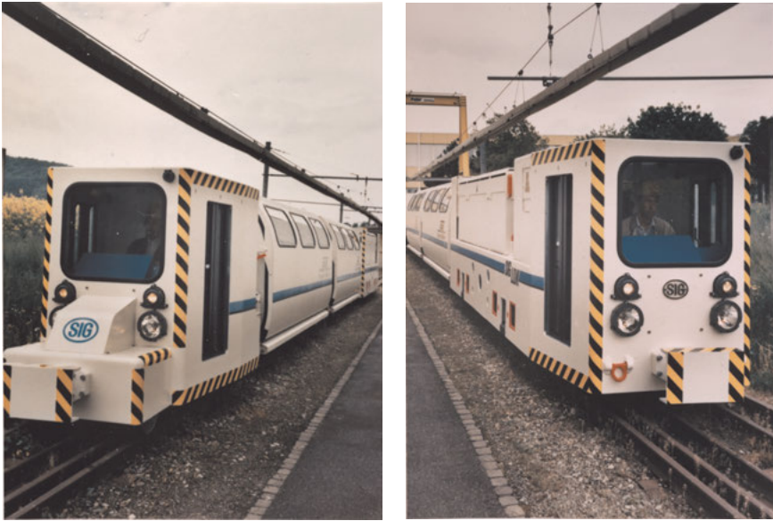
Abb. 11 und 12: Links Steuerstand des Prototypen-Zuges, rechts die Akkulokomotive
