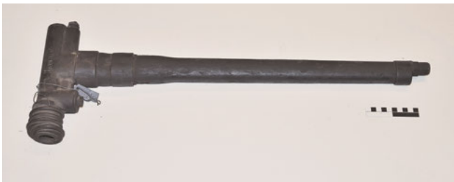
Abb. 6: Presslufthacke der Hauhinco-Maschinenfabrik, Type N, 1921
