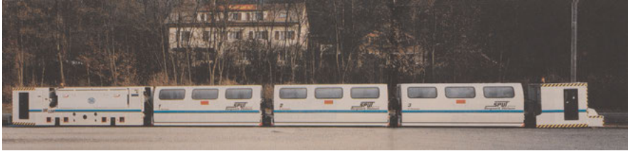
Abb. 13: Seitenansicht des Zug-Prototyps bestehend aus drei Personenwagen, der Akku-Lokomotive links und dem zweiten Fahrerstand rechts
