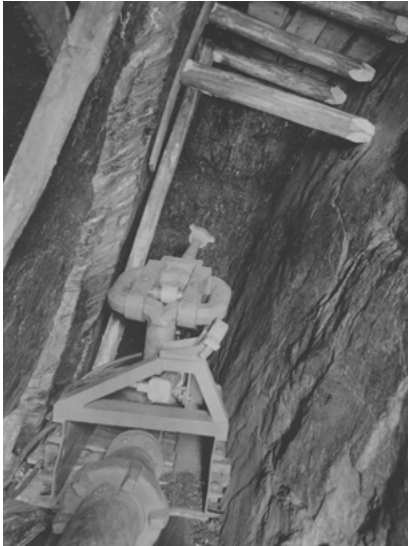
Abb. 7: Der erste Wasserwerfer beim Ausrichten des Gewinnungsortes in einer Störzone, November 1962. Beim Beginn des Spritzens war die Düse vom Kohlenstoß 1,5 m entfernt. Zunächst wurde die Gewinnungsstrecke 2 m vorgetrieben, bevor der Wasserwerfer umgesetzt werden musste, später musste dies erst nach 4 m erfolgen
