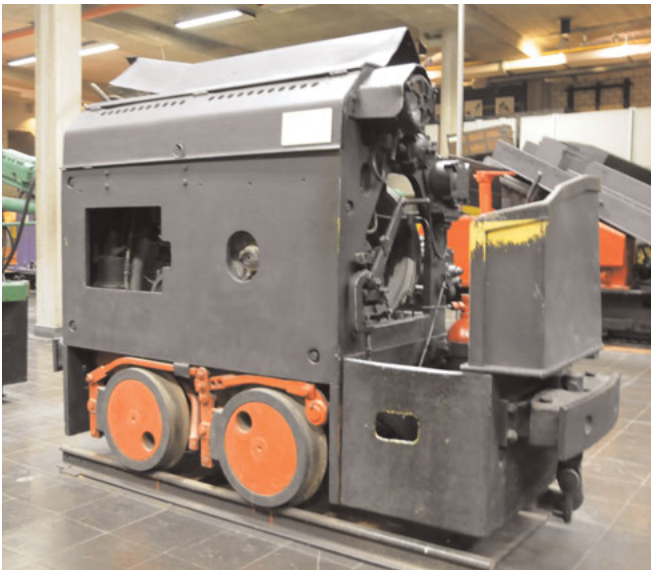
Abb. 5: Seitenansicht der Diesellokomotive der Klöckner-Humboldt-Deutz AG, Typ MAH 914/54, 1958
