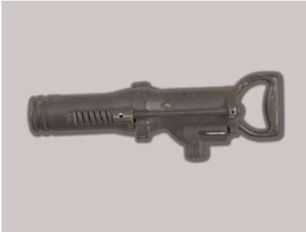
Abb. 8: Erste brauchbare Weiterentwicklung des ersten Bohrhammers, Type B, 1904
