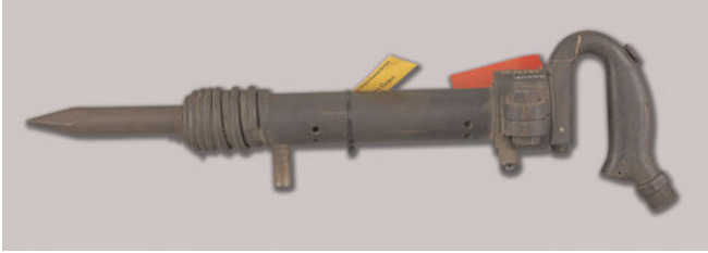
Abb. 5: Erster von Flottmann gebauter Abbauhammer, Type P1, 1907
