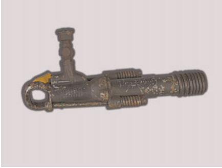
Abb. 12: 10 000. Bohrhammer der Firma Flottmann, Type B, 25.11.1909
