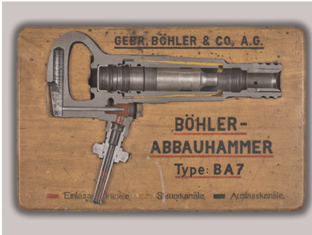
Abb. 3: Schnittmodell eines Abbauhammers, Type BA 7, Gebr. Böhler & Co. A. G.
