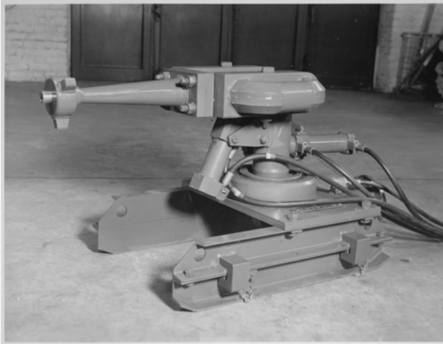
Abb. 5: Die Versuchskonstruktion eines Wasserwerfers von 1962
