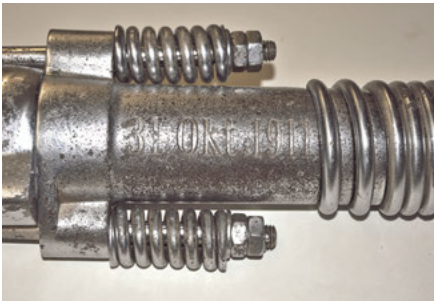
Abb. 13: Detailaufnahme des 20 000. Bohrhammers der Firma Flottmann, Type D, 31.10.1911. Gravur des Produktionsdatums am unteren Zylinder des Bohrhammers
