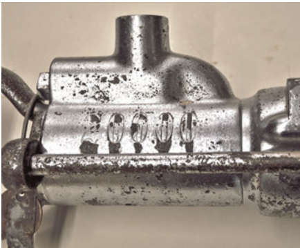
Abb. 14: Detailaufnahme des 20 000. Bohrhammers der Firma Flottmann, Type D, 31.10.1911. Gravur der Jubiläumszahl am seitlichen Lufteinlass des Bohrhammers
