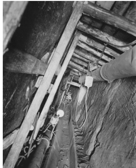
Abb. 8: Blick auf den Wasserwerfer wie in Abb. 2 vom Standort des Bedieners; links die Steuerung auf der Zuleitung des Druckwassers, mittig die Rinne zum Ableiten der Trübe
