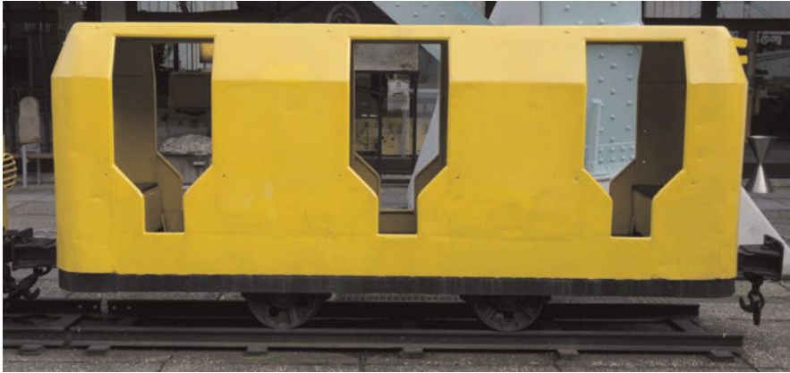
Abb. 4: Personenwagen der Zeche Zollverein für 12 Personen nach 1965. Gut zu sehen sind die im Fußbereich und im Kniebereich seitlich in die Einstiegsöffnung hineinragenden Schutzbleche. Fallgitter wie in Abb. 3 waren ebenfalls vorgeschrieben, fehlen aber an diesem Wagen
